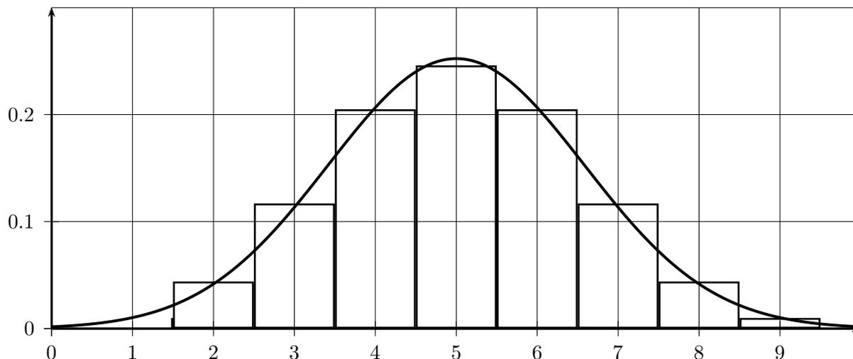
(d) on remarque que la courbe de la loi normale est une "bonne approximation" du diagramme en bâtons on décide alors de trouver une approximation de la probabilité  $p(4 \leq X \leq 6)$  en utilisant la courbe de la loi normale
